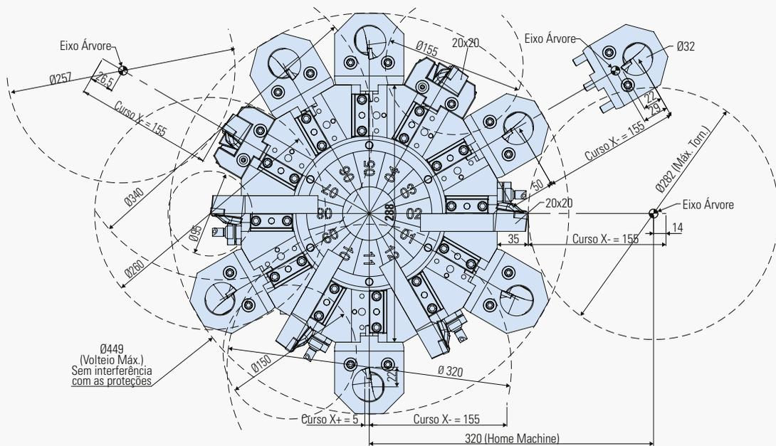
Ø449 (Volteio Máx.) Sem interferência com as proteções
