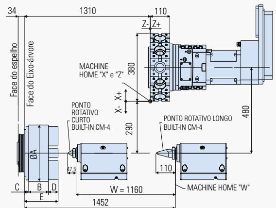
NOTA: Quando a peça estiver presa entre pontas, a área usinada próximo ao Cab. Móvel sofrerá alteração devido a interferência entre a Torre e o Cab. Móvel.
