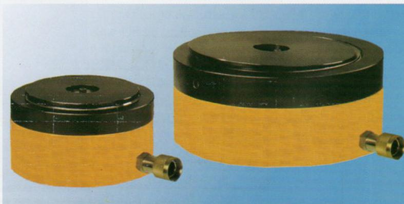
Cilindros de simples efecto, retorno por carga, extra-baixos com porca de segurança, para suportar mecânicamente a carga. Cabeça basculante para melhorar o comportamento ante cargas laterais.
