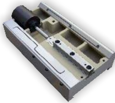
Carro transversal superior Guias inferiores revestidas com material anti-fricção
