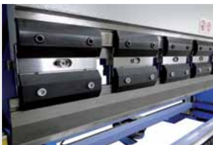
Fixação superior standard tipo Promecam, com aperto manual.
