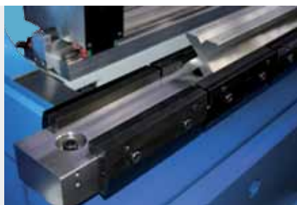
Bancada auto-centrante com fixação inferior standard e aperto manual.
