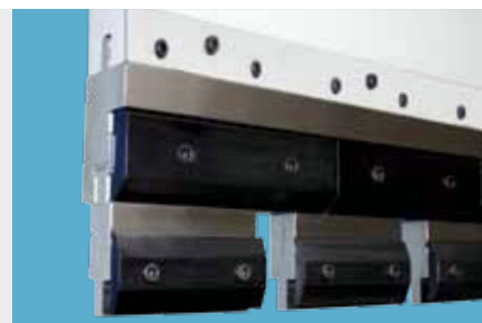
Fixação superior manual com reforço estrutural (Masselo).
