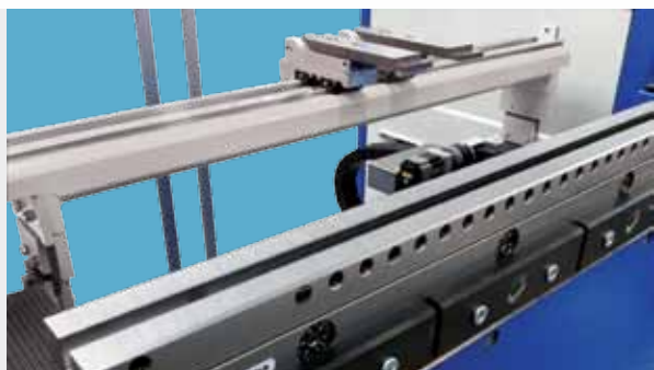
Mecânica GBS 2 eixos (X e R), com deslocamento frontal e aperto pneumático dos topos.
