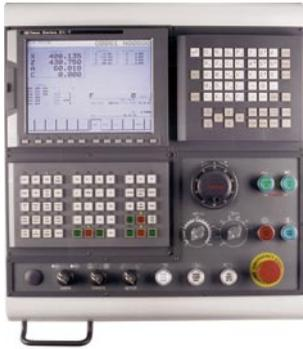
O CNC 21i - T possui *hardware* integrado à parte traseira do vídeo. Possui monitor LCD colorido de 10,4" com 12 *softkeys* (teclas multifunções) e duas interfaces de comunicação: tomada serial RS232 e *drive* para cartão PCMCIA, para transferência e armazenamento de dados.
