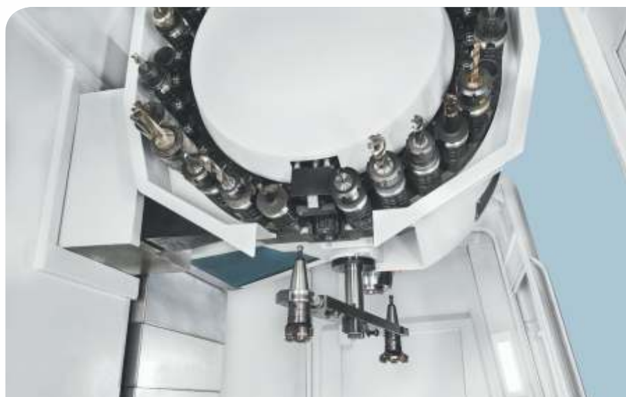
Trocador automático de ferramentas com capacidade para 30 ferramentas (ROMI D 800 / D 1000 / D 1250)
