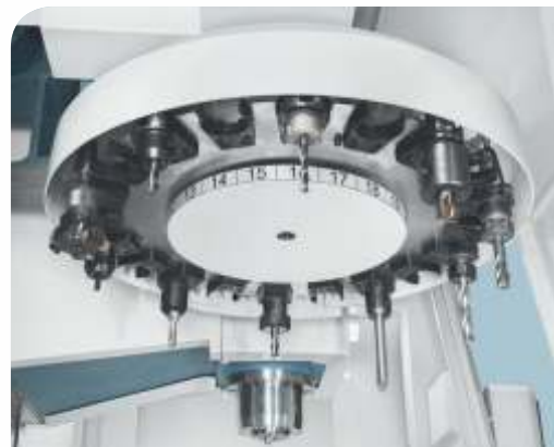
Trocador automático de ferramentas com capacidade para 20 ferramentas (ROMI D 600)
